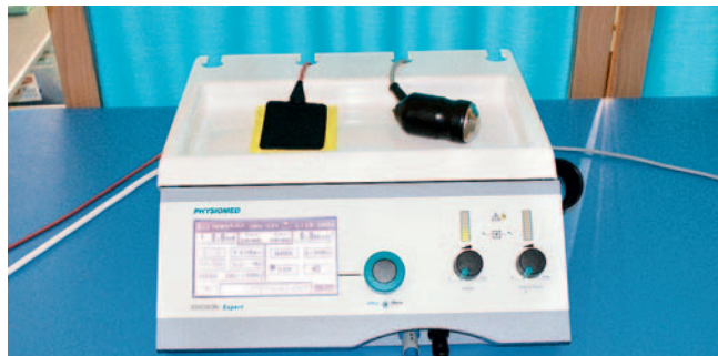
Fot. 1. Przykładowy aparat do terapii skojarzonej wraz z głowicą ultradźwiękową oraz elektrodą węglową i podkładem
